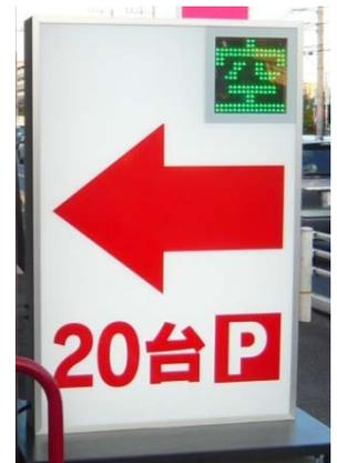
ラーメン一蘭様の出入口にループコイルを設置し車両カウントを行うシステムを導入しています。一定台数を超えると満車表示し、車が誤ってはいるのを事前に防ぎます。
